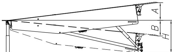
Рис. 1. Эффективная рабочая зона платформы
