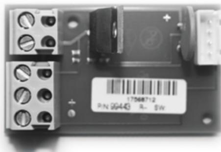
Модуль необходим для подключения сигнальной лампы **Control 950** к приводу **Comfort 270/280**.
