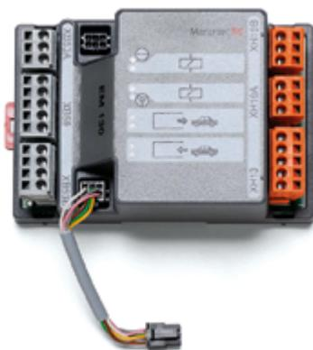
Модуль расширения позволяет организовать полноценную реверсивную регулировку транспортных потоков с помощью красной и зеленой светофорных ламп.
