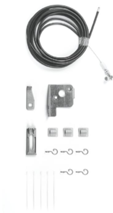
Трос разблокировки позволяет осуществить внешнюю механическую разблокировку привода снаружи в случаях, когда ворота необходимо перевести в ручной режим управления (например, при отсутствии основного источника питания).
