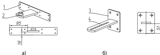
Рис. 63. Изготовление кронштейнов для установки электроприводов:
