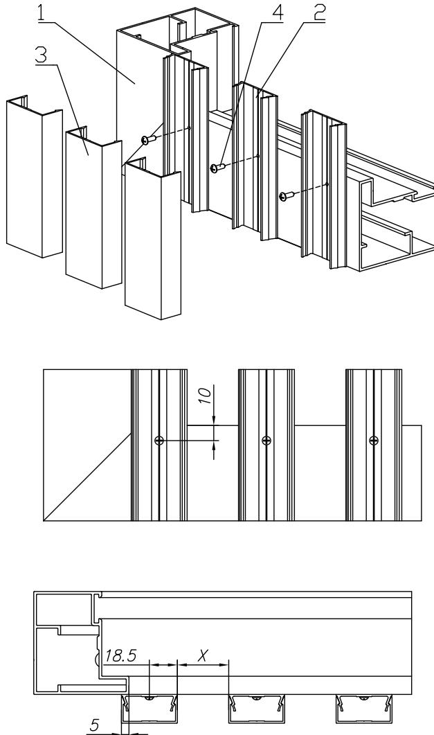
Рис. 28. Накладной тип монтажа разреженного заполнения профилем 37 мм:
