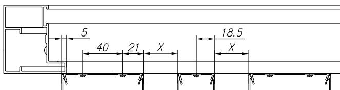
Рис. 29. Накладной тип монтажа разреженного заполнения комбинацией профилей 82 и 37 мм:
