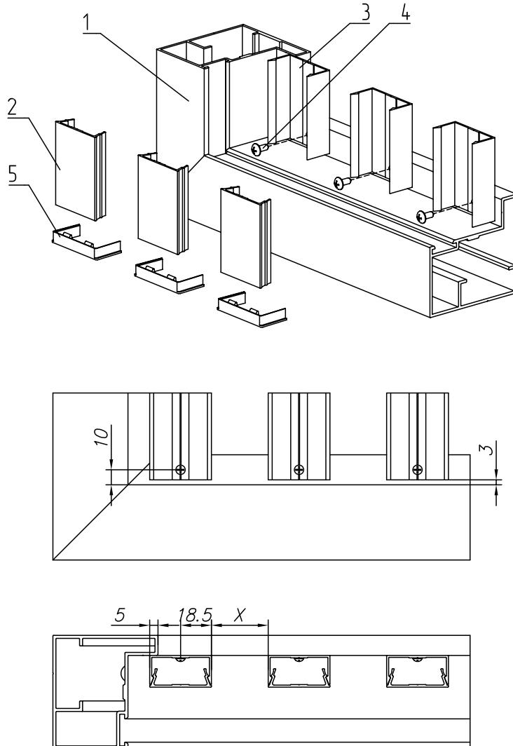
Рис. 25. Встроенный тип монтажа разреженного заполнения профилем 37 мм:
