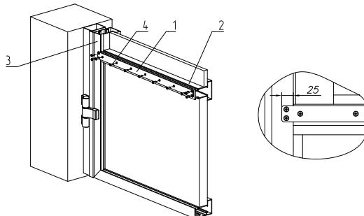
Рис. 64. Установка пластины FLGU.400.0946 (FLGU.400.0947)
