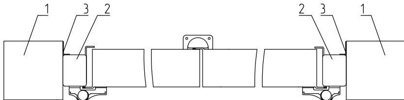
Рис. 66. Установка профиля притвора АYPC.120.2001
