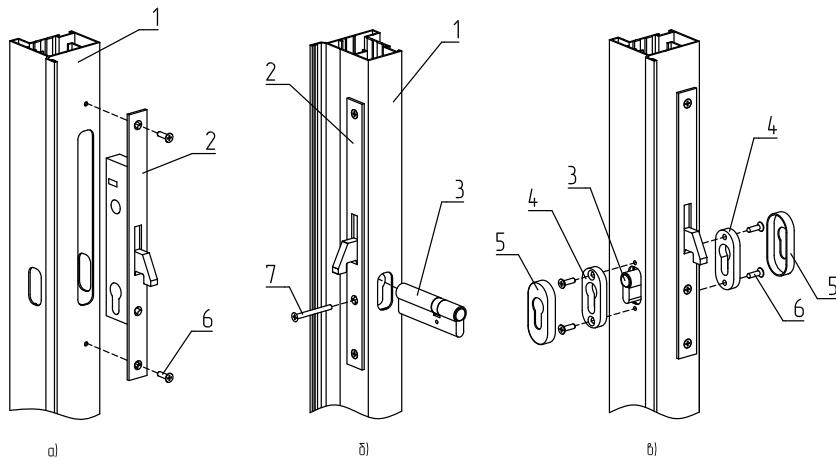
Рис. 47. Установка комплекта запирания
