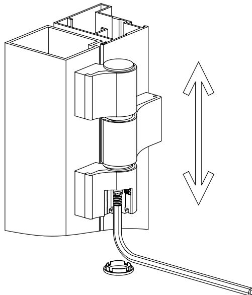
Рис. V. Регулировка петель FLGU.400.1002 в вертикальном направлении
