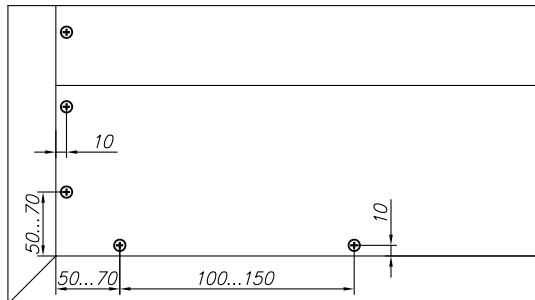
Рис. 15.2. Схема разметки
