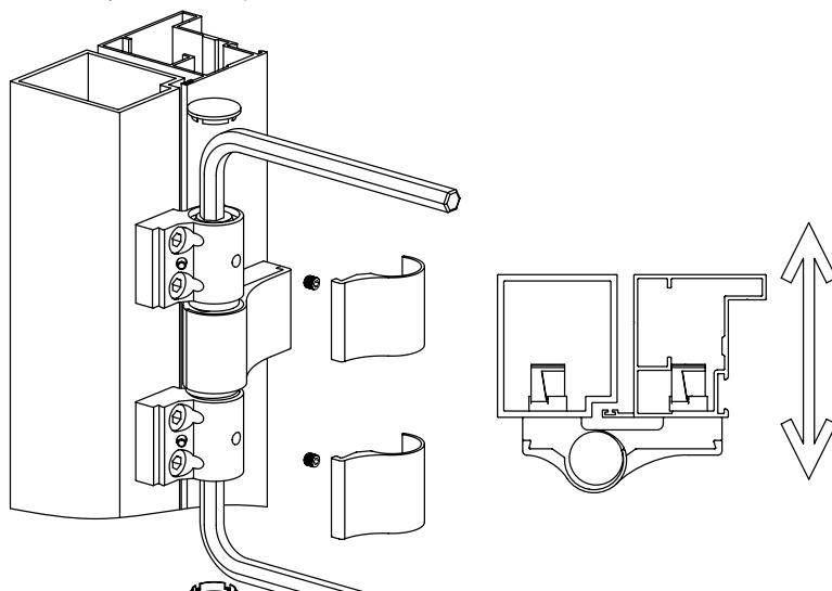
Рис. IV. Регулировка петли FLGU.400.1002 в горизонтальном поперечном направлении
