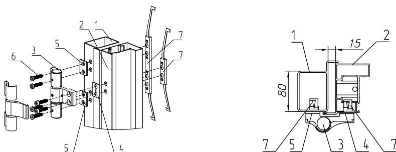
Рис. 6. Установка петли на стойку распашных ворот с видом открывания внутрь:
