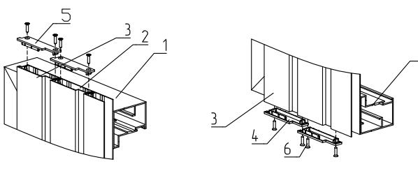
Рис. 36. Установка крышек сплошного заполнения:
