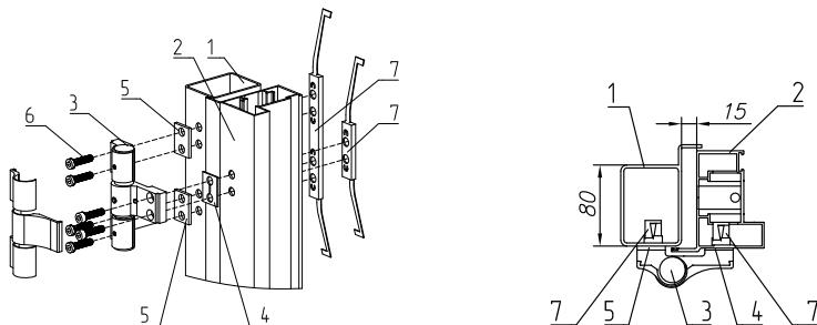
Рис. 5. Установка петли на стойку распашных ворот с видом открывания наружу:
