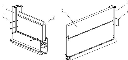
Рис. 16. Установка заполнения из сэндвич-панелей
