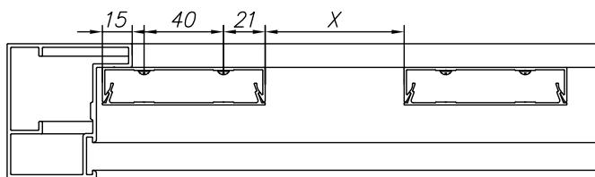
Рис. 24. Встроенный тип монтажа разреженного заполнения профилем 82 мм:
