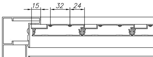
Рис. 30. Встроенный тип монтажа сплошного заполнения:
