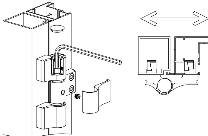
Рис. III. Регулировка петли FLGU.400.1002 в горизонтальном продольном направлении
