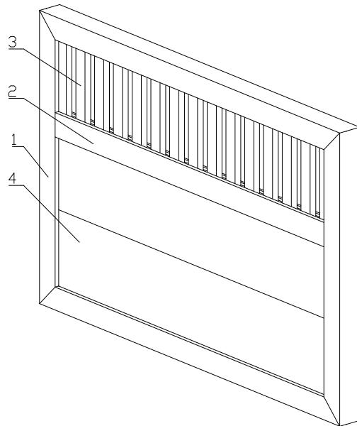
Рис. 37. Створка с комбинированным заполнением:
