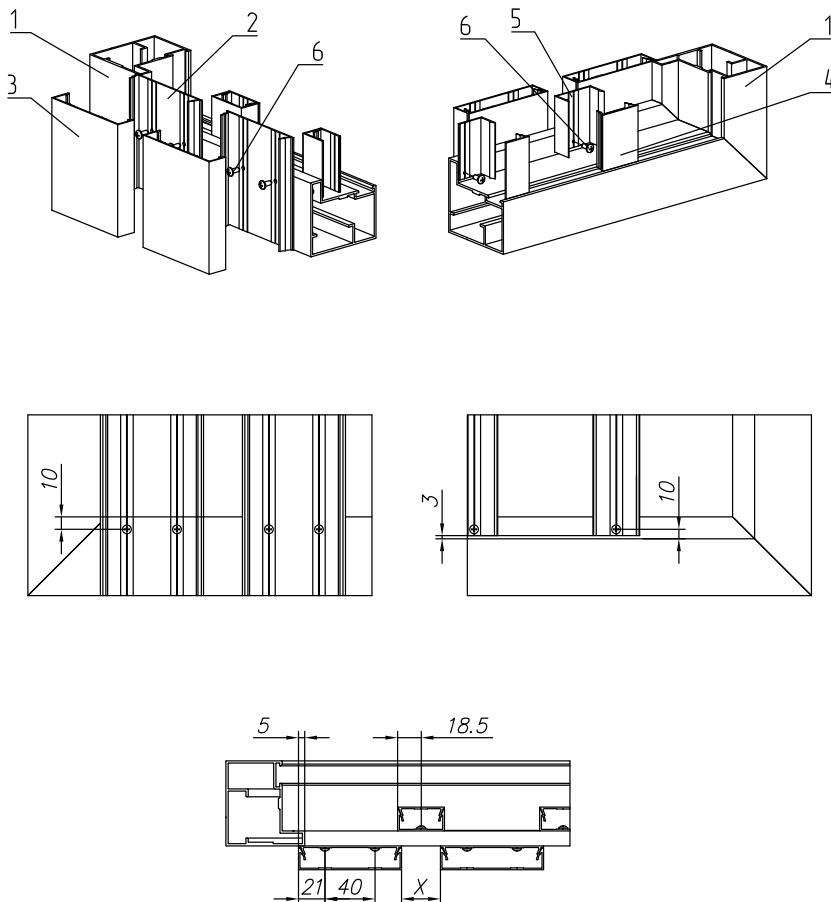
Рис. 29в — Шахматное заполнение профилями шириной 82 мм:
