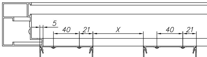
Рис. 27. Накладной тип монтажа разреженного заполнения профилем 82 мм:
