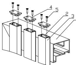
Рис. 35. Установка крышек FLGU.400.0703:
